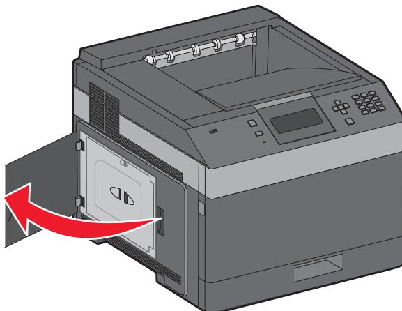
**2** Ослабьте винты на защитной крышке системной платы.
