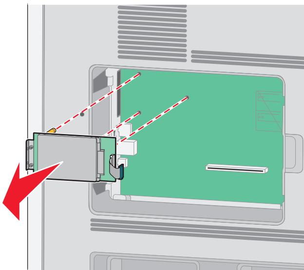
**Г** Удалите винты с накатной головкой, с помощью которых крепится кронштейн жесткого диска принтера к самому жесткому диску, а затем снимите кронштейн. Отложите жесткий диск принтера в сторону.
