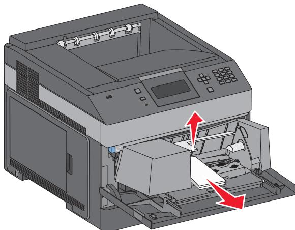
**2** Если замятый конверт не удается извлечь, приподнимите устройство подачи конвертов, извлеките его из принтера и отложите в сторону.
