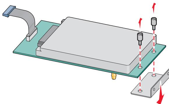
**4** Снимите металлическую крышку с отверстия порта ISP.
