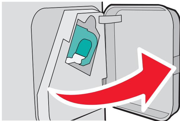
2 Потяните вниз фиксатор держателя кассеты со скобами и выньте держатель из принтера.
