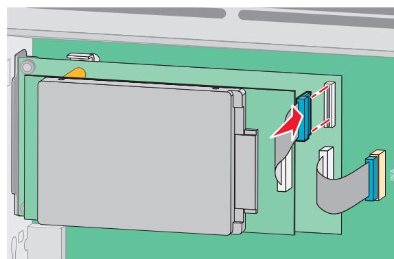
Установка жесткого диска принтера непосредственно на системную плату:
