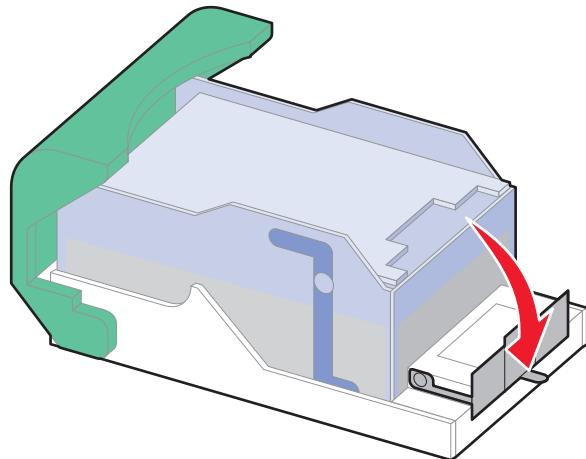
**5** Нажмите на держатель картриджа до щелчка, чтобы плотно закрепить его в сшивателе.
