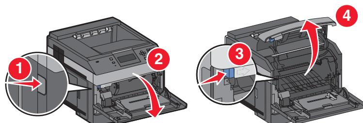
**3** Приподнимите и вытяните картридж с тонером из принтера.
