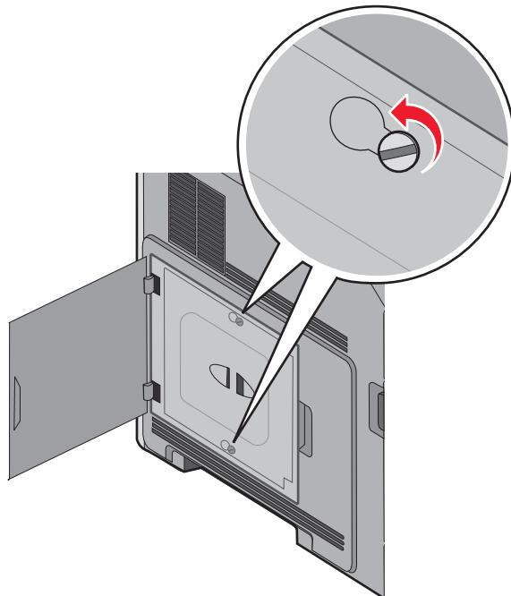
**3** Снимите защитную крышку системной платы.
